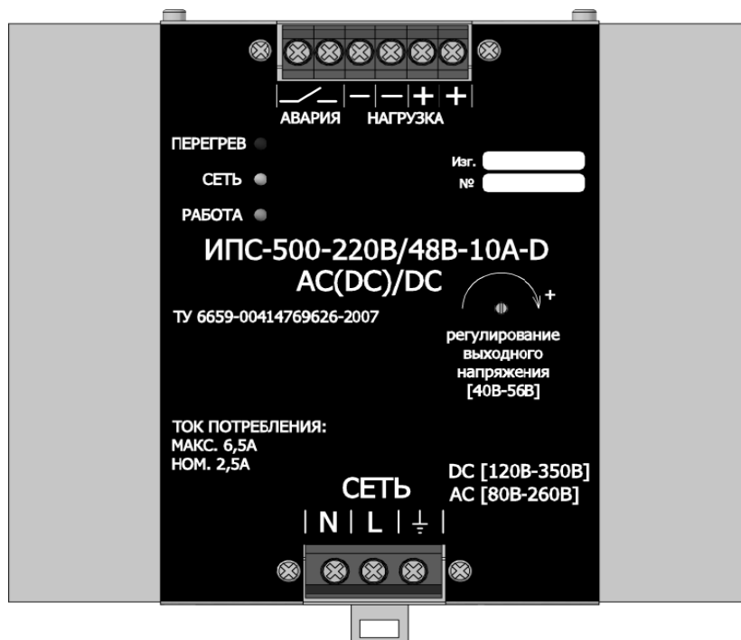
Рисунок 3. Вид спереди ИПС-500-220В/48В-10А-D (AC(DC)/DC) .
